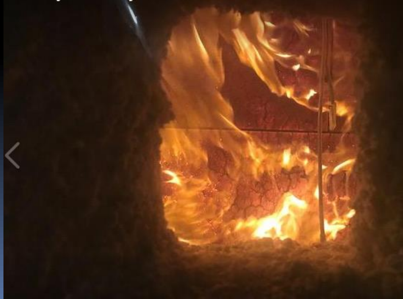
Požiarne test slamy z exteriéru
