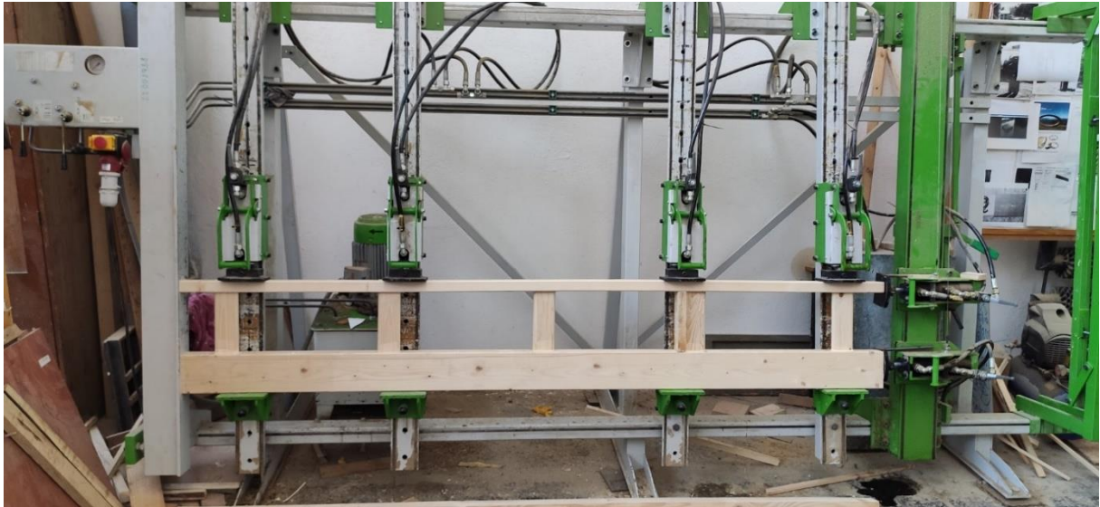
Obrázok 9. Výroba prototypových vyľahčených rebríkových nosníkov. (foto: R. Uhrín).
