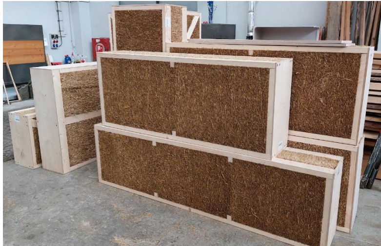
Obrázok 3. Dreveno-slamený konštrukčný systém EcoCocon. (foto: P. Štopf).
